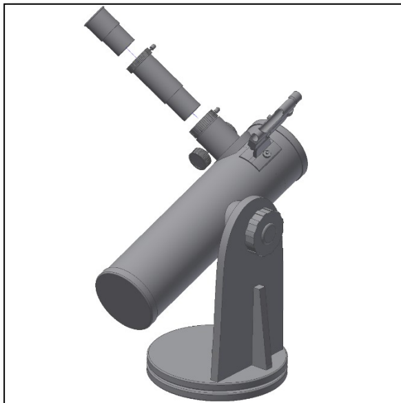
Abb. 4. Nutzung des Okulars mit optionaler Barlowlinse.
